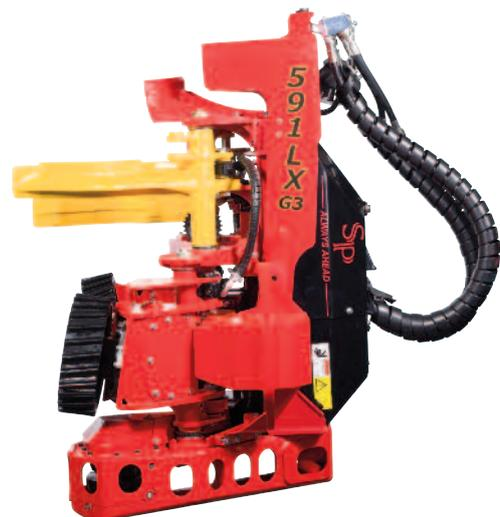
4. Die Zylinderwellen sind sowohl gehärtet als auch chromatiert und außerdem mit sehr großem Durchmesser ausgebildet. Die Wellen der Entastungsmesser, Motorarme und Tiltbrücke sind in Expanderausführung mit sehr großem Durchmesser und vollkommen gegen Schmutzeintritt abgedichtet. Diese außergewöhnlichen Lösungen gewährleisten maximale Lebensdauer und Betriebssicherheit sowie minimalen Unterhaltsbedarf.
