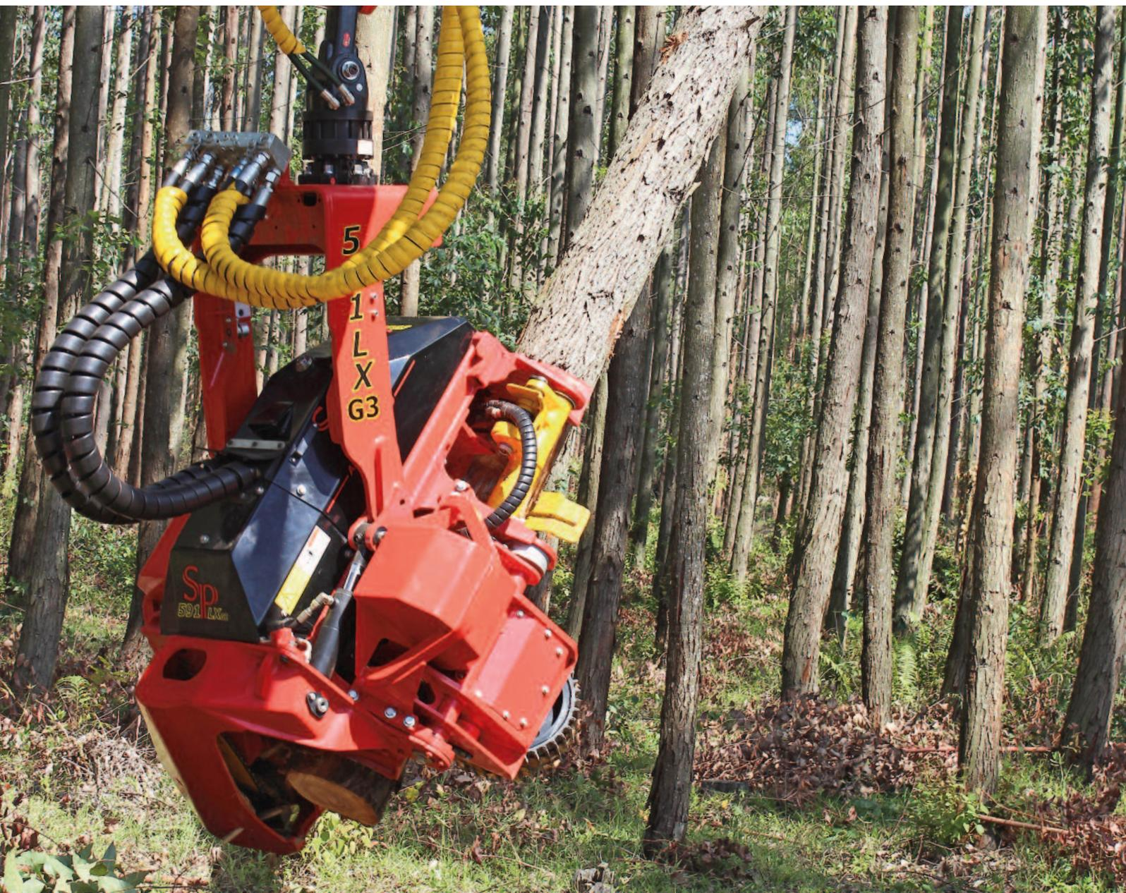
1. Der Rahmen besteht aus dickwandigem Grobblech aus hochfestem Spezialstahl. In Kombination mit der kompakten Konstruktion verleiht dies dem Rahmen extreme Stärke und Verwindungssteifheit. Für Maximierung der Rahmenstärke und Minimierung der Spannungen im Material erfolgt die gesamte Bearbeitung erst nach dem Schweißen. Starke im Rahmen angeordnete Gleitbleche verteilen den vom Stamm ausgehenden Druck, was minimalen Verschleiß und Unterhaltsbedarf gewährleistet.
