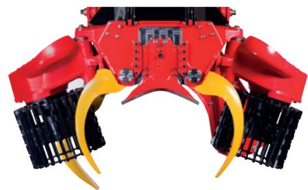
vollständig geöffnet, dann bietet ihr maximaler Öffnungswinkel auch maximale Tragkraft für den Stamm. Hierdurch kann ein minimaler Druck auf die Entastungsmesser ausgeübt werden, wodurch die Reibung reduziert wird und das Aggregat den Stamm schnell und einfach vorschieben kann. Bei geschlossenen Vorschubwalzen bietet diese einzigartige Lösung ein unglaublich schmales und wendiges Aggregat mit kompakten Maßen.
