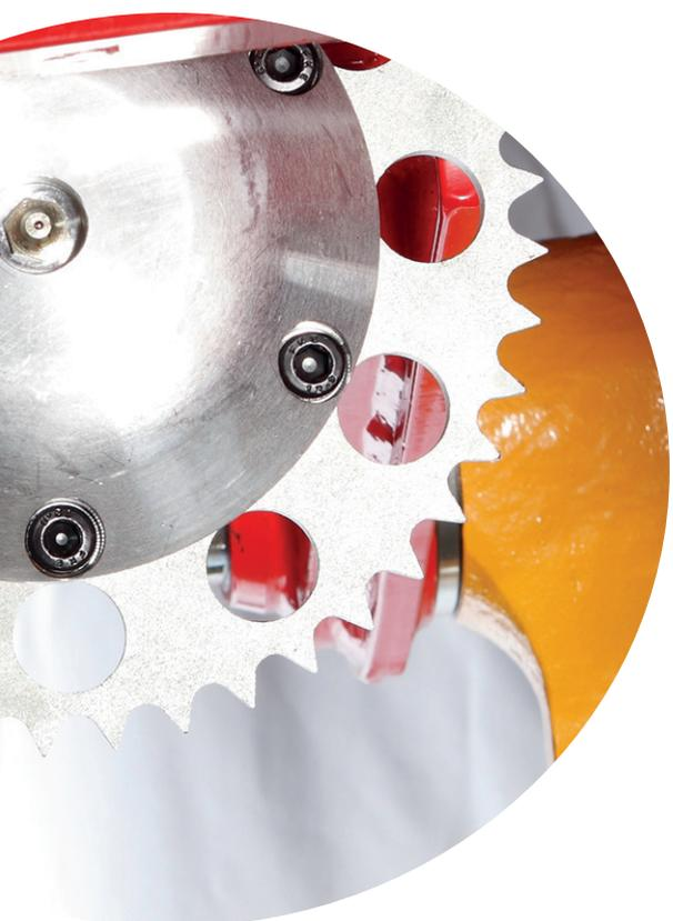
Betätigt wird **die Längenmesseinheit** durch einen extrem gut geschützten Hydraulikzylinder und über ummantelte Schläuche. Das Messrad kann sich so bei geöffnetem Aggregat in eine geschützte Lage zurückziehen.
