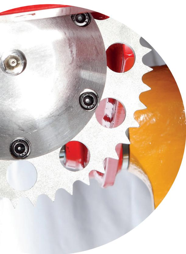
**L'unité de mesure de la longueur** est actionnée par un vérin hydraulique extrêmement bien protégé et des flexibles encapsulés. La roue de mesure peut donc être rétractée en position protégée lorsque la tête est ouverte.
