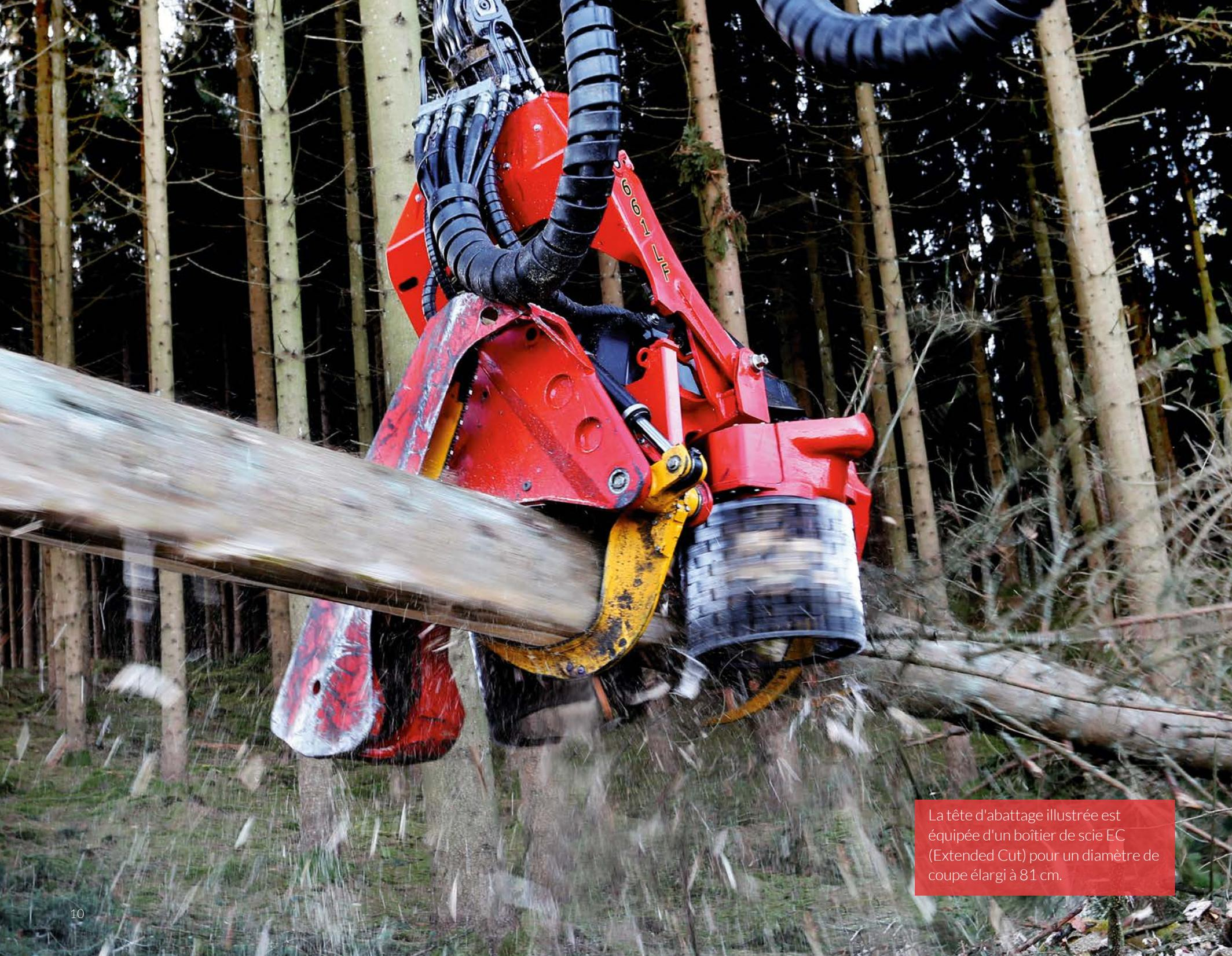
La tête d'abattage illustrée est équipée d'un boîtier de scie EC (Extended Cut) pour un diamètre de coupe élargi à 81 cm.
