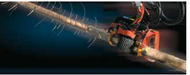
El SPd5Bucking es un completo sistema de medición y manejo para el control del proceso de tala en los cabezales cosechadores. El SPd5Bucking es nuestro sistema más avanzado, compatible con el tronzado por valor. Este sistema también está completamente integrado en el sistema de comunicación y manejo dasa5.
