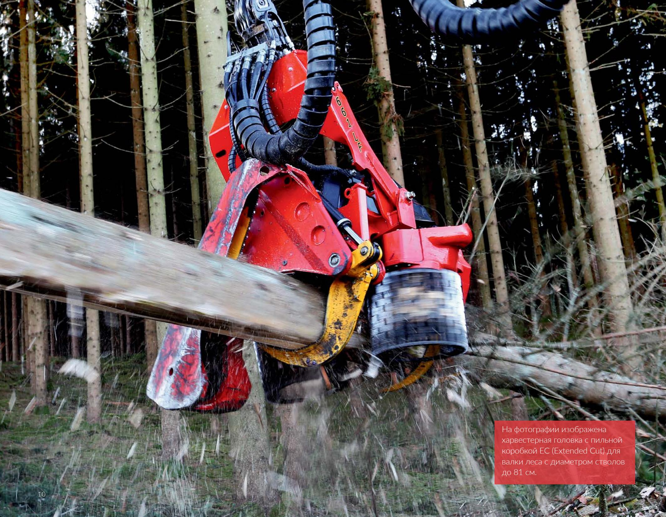
На фотографии изображена харвестерная головка с пильной коробкой EC (Extended Cut) для валки леса с диаметром стволов до 81 см.
