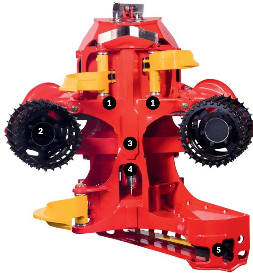
1. Надежные бесконтактные кодирующие устройства для измерения диаметра установлены в полностью герметичных стальных корпусах, расположенных внутри рамы для обеспечения максимальной защиты и долговечности.
